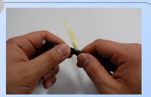
Spingere la copertura in basso chiudendo il supporto. Invitare il tappo a vite in modo da fissare il filamento del cavo. Tagliare il filamento e sistemarlo,
