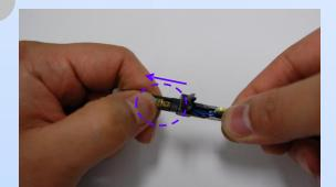
Mantenendo il cavo curvato, spostare in avanti il supporto, bloccando il cavo.
