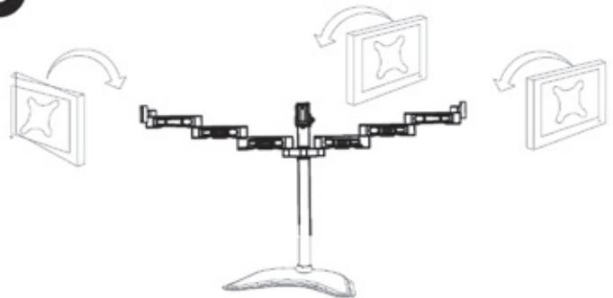
Per completare l'installazione, semplicemente infilate il supporto col monitor nel supporto fisso sul palo
