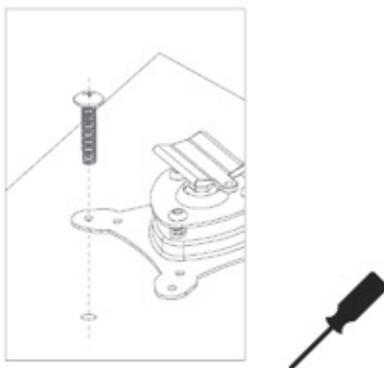
Installare il monitor LCD al supporto usando gli accessori forniti
