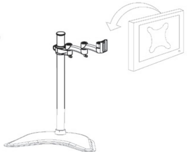
Per completare l'installazione, semplicemente infilate il supporto col monitor nel supporto fisso sul palo
