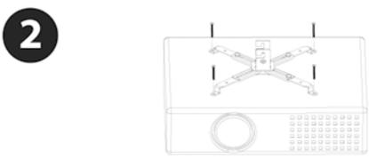
**2** Attaccate il proiettore ai bracci di montaggio (O) usando il bullone adeguato (D, E, F). Se nessuno dei bulloni forniti è adeguato, chiedete al produttore del proiettore la dimensione corretta. Una volta collegati i bracci, stringete tutte le viti e i bulloni.
