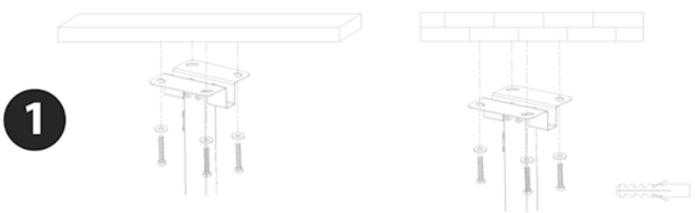
**1** Installare la parte superiore (M) al soffitto usando le viti (A). Se il supporto viene installato su un soffitto di cemento, usate anche i tasselli (B).
