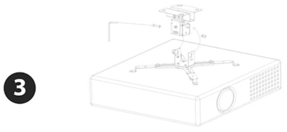
**3** Collegate con attenzione la base di montaggio (L) al vostro proiettore attaccato al blocco di connessione (N). Usando le viti adeguate fissate il proiettore in modo da non farlo uscire dal blocco di connessione. L'installazione ora è completa.
