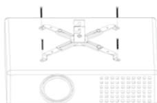
3 Attaccate il proiettore ai bracci di montaggio (M) usando il bullone adeguato (E, F, G, H). Se nessuno dei bulloni forniti è adeguato, chiedete al produttore del proiettore la dimensione corretta. Una volta collegati i bracci, stringete tutte le viti e i bulloni.
