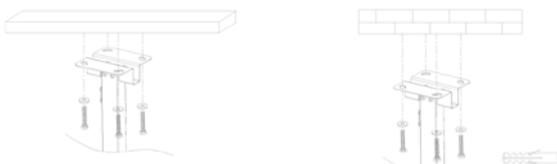
Installare la parte superiore (N) al soffitto usando le viti (A). Se il supporto viene installato su un soffitto di cemento, usate anche i tasselli (B).
