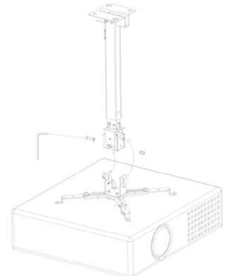
Collegate con attenzione la base di montaggio (L) al vostro proiettore attaccato al blocco di connessione (O). Usando le viti adeguate fissate il proiettore in modo da non farlo uscire dal blocco di connessione. L'installazione ora è completa.
