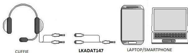
Collegare i connettori ai dispositivi audio. Non è necessario spegnere i dispositivi in uso. Non è necessario installare driver.
