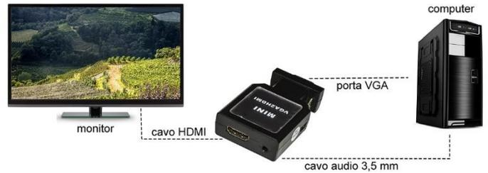
Collegare l'adattatore alla porta VGA del PC o notebook. Collegare il cavo audio 3.5mm alla presa della scheda audio del PC o notebook. Collegare il cavo HDMI alla presa HDMI dell'adattatore.
