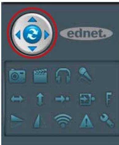
Der Bewegungskontrollbereich dient dazu die Kamera automatisch oder manuell zu steuern. Der mittlere Bereich bewegt die Kamera automatisch in alle Richtungen, mit den jeweiligen Pfeilen im Außenbereich kann die Kamera manuell gesteuert werden.
