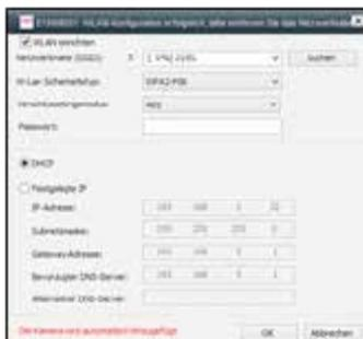
Aktivieren Sie die WLAN-Funktion der Kamera, indem Sie auf „WLAN einrichten“ klicken und suchen Sie dann nach verfügbaren drahtlosen Netzwerken.
