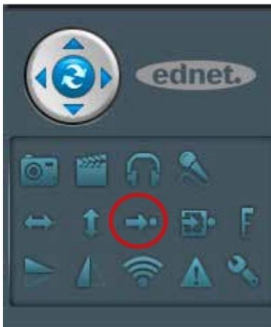
Mit dieser Funktion können Sie die Kamera zu einem zuvor festgelegten Punkt steuern. Es können 8 verschiedene Punkte gespeichert werden.
