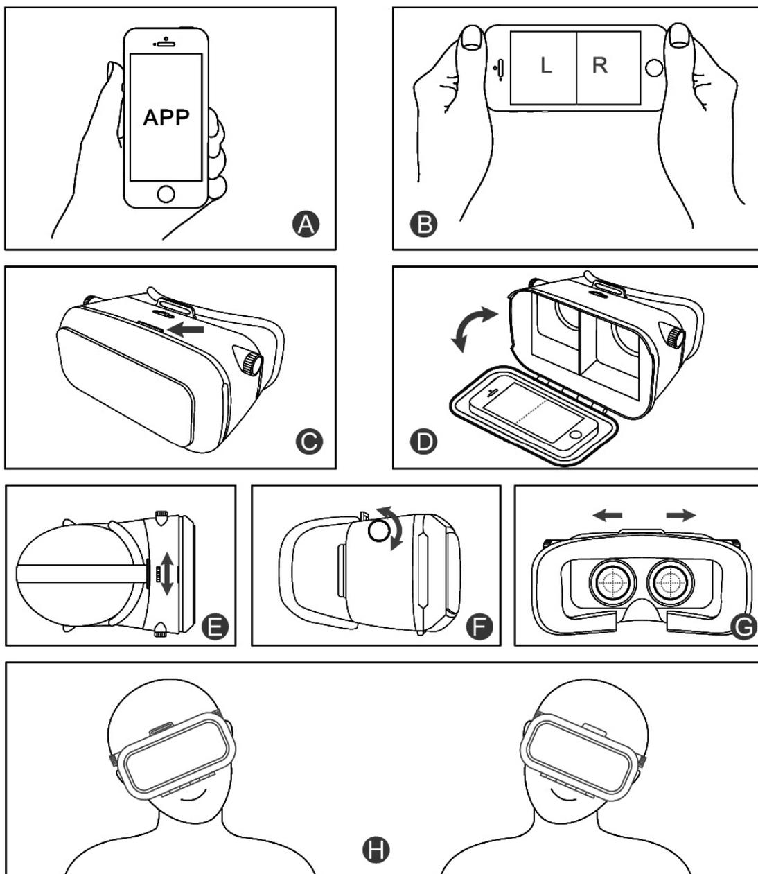
Öffnen Sie oben vorsichtig den Schalter für die Adsorptionsart (siehe Abbildung C) und halten Sie das Smartphone so, dass der Bildschirm nach innen zeigt. Fassen Sie vorsichtig den Skalenanpassungs-Kartenschlitz und setzen Sie Ihr Smartphone ein. Schließen Sie anschließend die Abdeckung (siehe Abbildung D). Wenn Sie das Bild auf dem Kopf steht, ändern Sie die Ausrichtung des Smartphones
