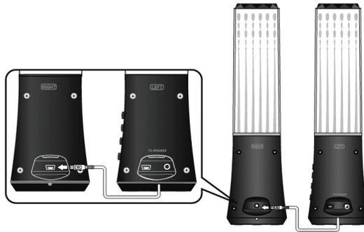
1. Schließen Sie den linken Lautsprecher rechts mit seinem Kabel an.
