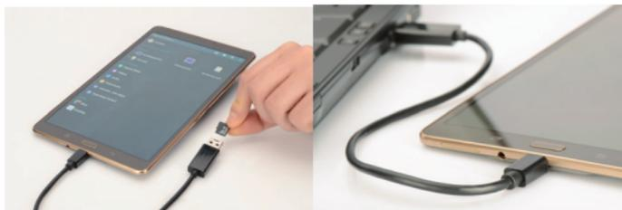
**Achtung:** Das Kabel vorsichtig einstecken und trennen. Unterschiedliche Speicherkapazitäten sind durch Einstecken von verschiedenen microSD-Karten möglich. Der USB 2.0 Typ A-Port braucht beim Anschluss an einen PC oder Netzadapter ca. 6 Sek. zum Reagieren.
