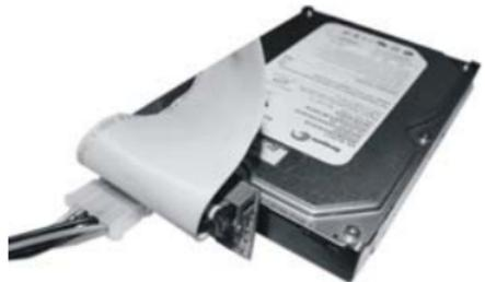
***Hinweis: Stellen Sie bitte sicher, dass Ihr PC während der Hardwareinstallation ausgeschaltet ist. Dieser SATA/150-PATA-Converter in Verbindung mit Ihrem SATA-Gerät ist nicht Hot-Swap-fähig. Schalten Sie bitte Ihren Computer aus, bevor Sie dieses Gerät anschließen.***
