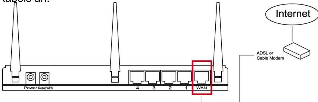
2. Schließen Sie alle Ihre Rechner, Netzwerkgeräte (netzwerkfähige Abnahmegeräte außer Computer, wie z.B. Spielkonsolen, oder Schalter / Hub) an den LAN-Port des Routers an.
