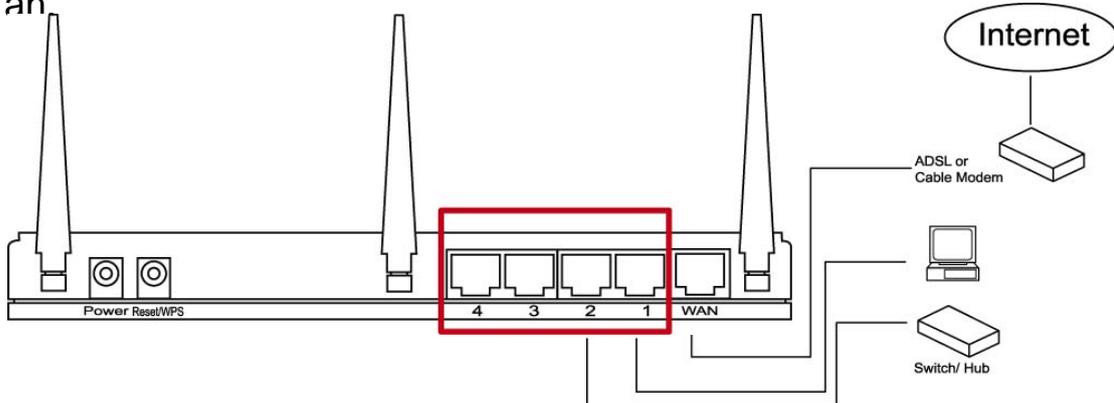
3. Schließen Sie den Wechselstrom-Adapter an die Anschlussdose an, und schließen Sie ihn dann an die Stromversorgung des Routers an.
