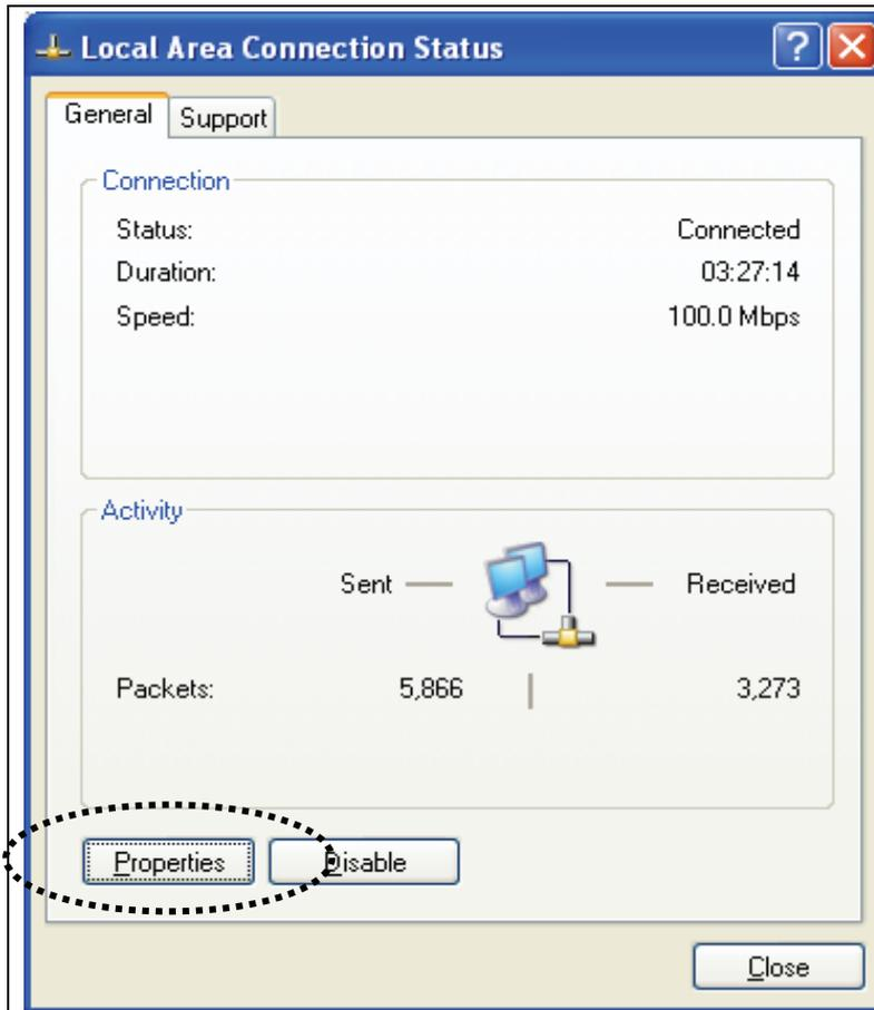
1. Configurar su ordenador para obtener una dirección IP desde el router inalámbrico: haga clic en el botón 'Start' (debe encontrarse en la esquina inferior izquierda de la pantalla), después haga clic en el panel de control. Haga doble clic en **Network Connections**, después haga doble clic en **Local Area Connection** y haga clic en 'Properties'.
