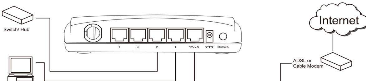
3. Ligar o adaptador A/C à tomada de parede, e depois ligá-lo à tomada de "Alimentação" do encaminhador.
