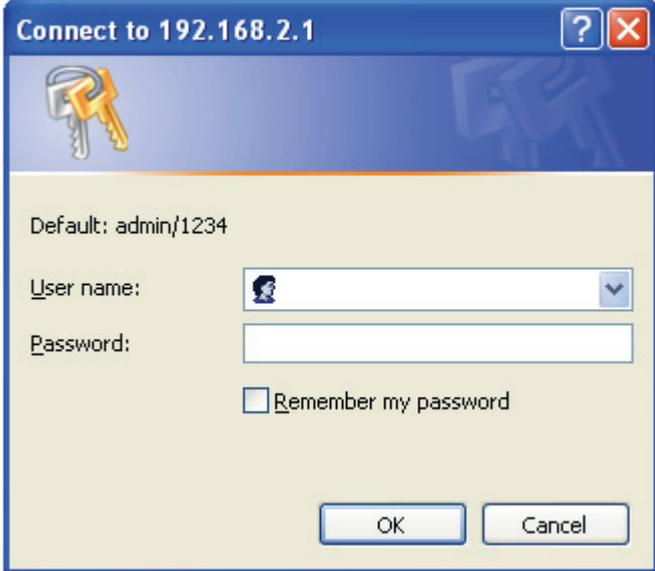
6. Iniciar o motor de busca e introduzir o endereço IP do encaminhador sem fios na barra de endereço, e deverá ser mostrada a seguinte mensagem. Deve introduzir o nome do utilizador e a palavra-passe, depois clicar em 'OK' para aceder ao interface de gestão de internet do encaminhador sem fios.
