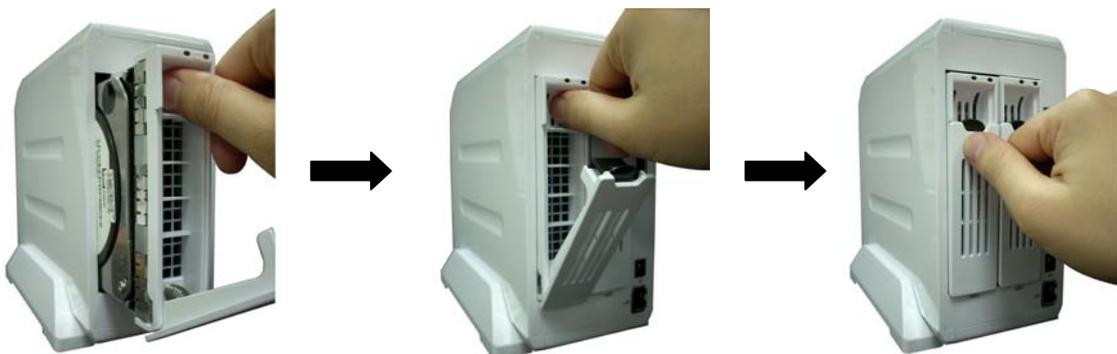
**Hinweis:** Achten Sie bitte darauf, dass der Laufwerkseinschub sicher installiert ist.
