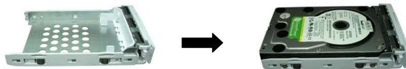
3. Den Einschub mitsamt dem darin installierten Festplattenlaufwerk gemäß der folgenden Abbildung wieder in das Speicherservergehäuse einsetzen.
