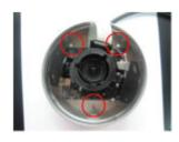
Tre buchi vite per fissare la videocamera sul soffitto
