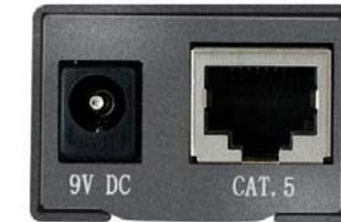
Netzbuchse Kat. 5 (RJ-45-Buchse)
