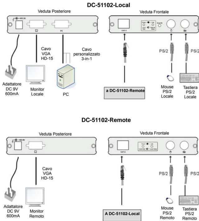
1. Collegare la porta del quadro di comando del PC usando un cavo standard 3-in-1 a Locale. (Prima college il mouse PS/2, poi college la tastiera PS/2 e il connettore VGA).
