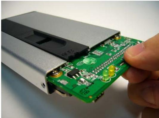
5. Allontanare la vite, ed infilare la nuova nello slot. Quando il nuovo disco è sistemato, rimontare come mostrato nei passi da 3 a 9.
