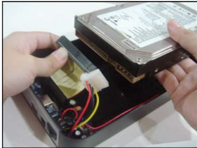
2. Bauen Sie die PATA-Festplatte ein.
