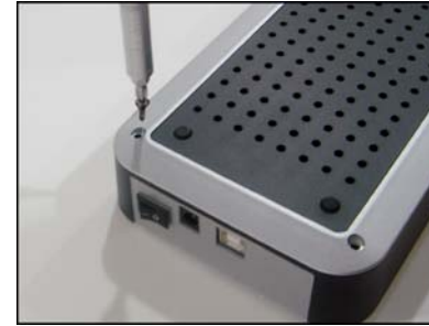
7. Drehen Sie Schrauben (2 längere, 2 kürzere) in das Unterteil des HD- Laufwerks ein, um es abzudichten.
