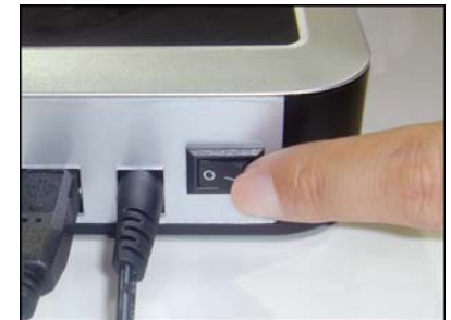
12. Schalten Sie den Netzschalter ein.
