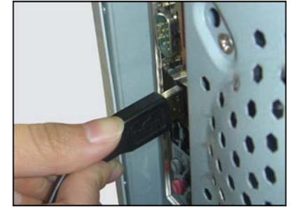
10. Stecken Sie das USB-Kabel in den PC oder Laptop.
