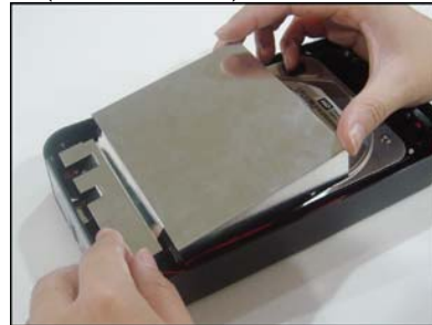
5. Setzen Sie die PCB-Abschirmung auf den PCBA.
