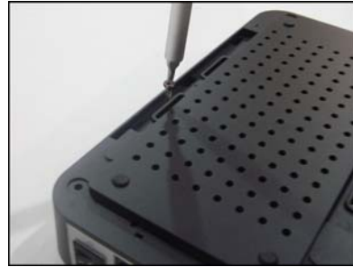
4. Ziehen Sie die Schrauben am Unterteil des HD- Laufwerks fest an, um die Festplatte zu befestigen (4 Kurzschrauben).
