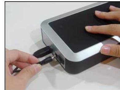
9. Stecken Sie den Adapter in das HD-Laufwerk.
