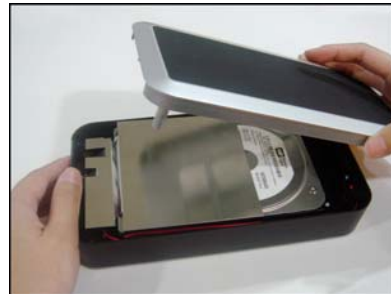
6. Setzen Sie die Abdeckung wieder auf das HD-Laufwerk.
