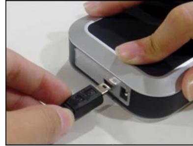
7. Plug mini USB into the HD enclosure
