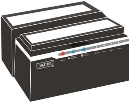
c. Drücken Sie die Klonen-Taste und halten Sie sie 3 Sekunden lang gedrückt, bis die Kontrollleuchte aufleuchtet. Drücken Sie dann die Klonen-Taste nochmals kurz, um den Start des Klonens zu bestätigen. Der Kopiervorgang beginnt nun.
