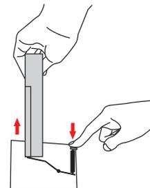
Diseño de la patente para HDD a partir de la unidad de acoplamiento (Al pulsar el botón, por favor, sujete el disco duro al mismo tiempo)
