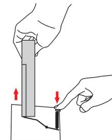
Diseño de la patente para HDD a partir de la unidad de acoplamiento (Al pulsar el botón, por favor, sujete el disco duro al mismo tiempo)
