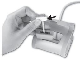
Ziehen Sie das Kabel soweit durch, bis sich der Dockinganschluss mit dieser Seite [↔] oben in der Anschlussbuchse befindet
