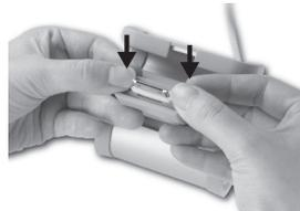
Schieben Sie den Dockinganschluss mit beiden Daumen in die Anschlussbuchse
