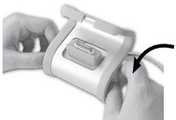
Drehen Sie den Drehknopf an den Seiten mit beiden Händen, so dass sich die Anschlussbuchse in Ihre Richtung neigt
