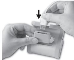
Ziehen Sie das Kabel durch die Anschlussbuchse
